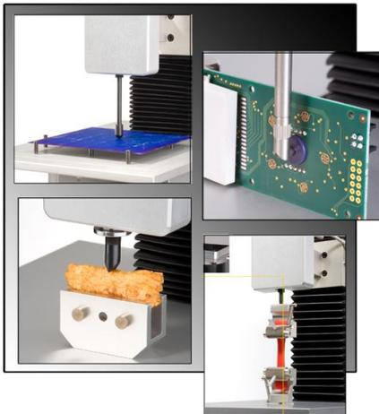
Der FMT-311 Force Tester ist eine sehr präzise arbeitende Universal-Prüfmaschine mit Kugelspindeltrieb. Die hohe Genauigkeit der Kraft-, Weg- und Zeitmessung, kombiniert mit einer flexiblen Steuerung, ermöglicht den Einsatz in unterschiedlichsten Anwendungsgebieten.
